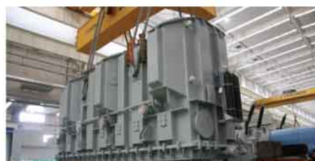
Пуэрто-Рико: трансформатор USA230kV 570MVA
