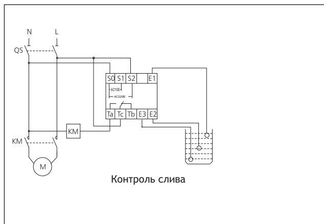
Для NJYW1-NL1, NJYW1-NL2 напряжение питания 110V/220В
